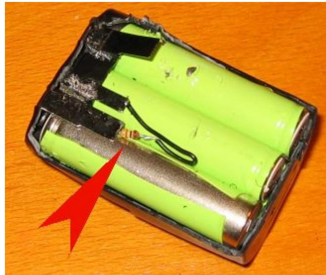
Beim echten Canon-Akku ist am dritten Anschluß ein NTC angeschlossen, mit dem das Ladegerät die Temperatur im Akkupack überwacht:
