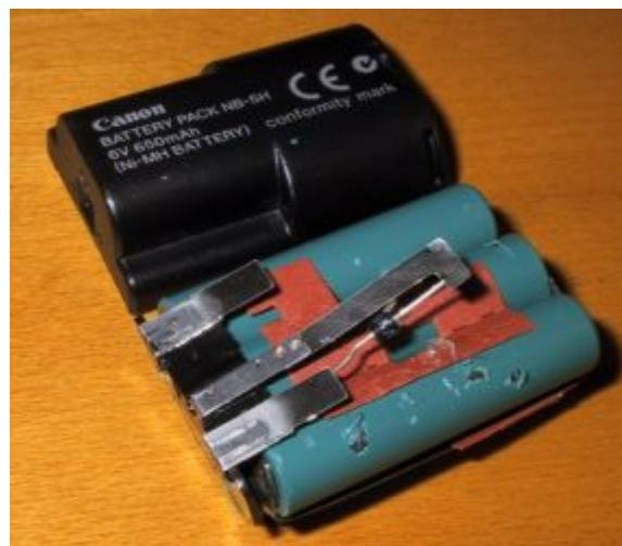
Zusätzlich ist beim Canon Akku noch eine Art Polyswitch-Sicherung eingebaut:
