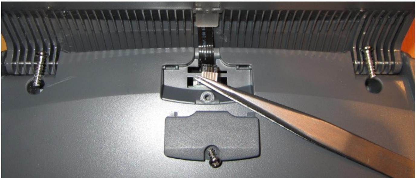
Nun hinten rechts mit einer Plastikkarte (Telefon oder Kreditkarte oder sowas) das Gehäuse leicht öffnen
