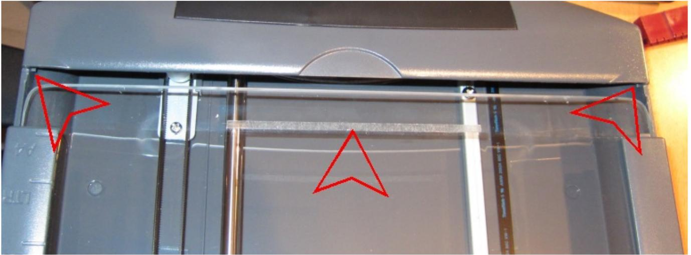
Fertig ! Damit kann das Glas abgehoben und gereinigt werden. Beim Zusammenbau die Scheibe vorne leicht schräg reinschieben und dann flach hineindrücken bis die Rastnasen zu hören sind. Abschließen dann alle Rastnasen wieder einklipsen und die Schrauben und das Flachbandkabel wieder einbauen - fertig.
