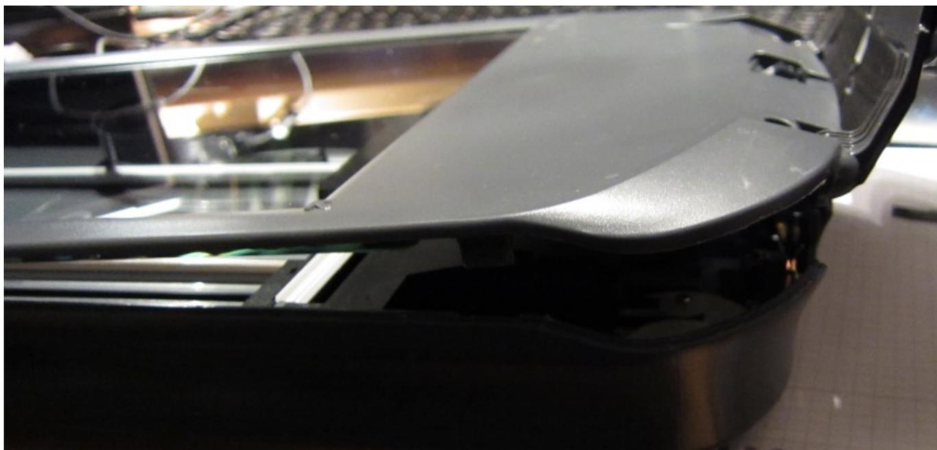
Vorne dann das Scannerglas aus den Halterung herausschnappen. Was beim ersten mal stört ist der in der Mitte markierte Kleber. Erfordert etwas Kraft und Mut beim zerlegen ...
