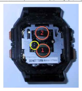
Die Bleche 1 und 2 auf der rechten Seite mit z.B. einem kleinen Schraubendreher oder Messer lösen und die Batterien entnehmen. Die gelb markierte Feder nicht verlieren !
