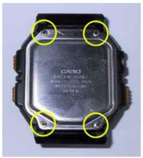
4 Schrauben lösen, beim abheben des Deckels auf das Dichtungsgummi acht geben. Möglichst nicht auf der Rückseite des Edelstahldeckels die Kontaktfläche des Piezo-Kristalls berühren. Im Uhren-Modul liegt noch eine kleine Spiralfeder, die den Piezo kontaktiert. Diese ist nirgends befestigt und kann leicht herausfallen.
