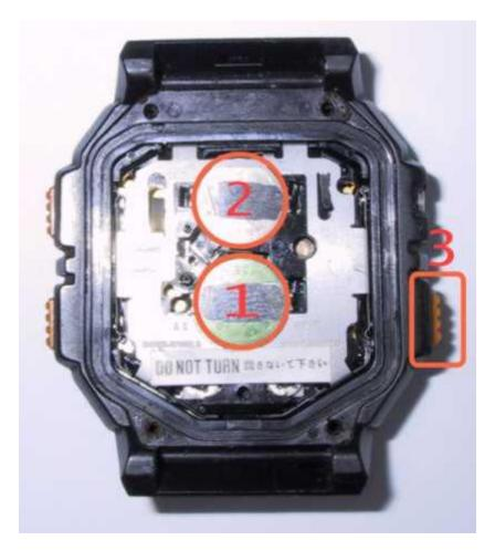
Dafür brauchen wir 2 Stück Silberoxid Knopfzellen Typ 395 (auch D395 oder V395 genannt). Die haben Aussenabmessungen von 9,5×2,6mm, eine Spannung von 1,5-1,55 Volt und eine Kapazität von um die 46mAh. Pro Stück kosten die so zwischen 3,5-6,5DM. Ob der Hersteller jetzt Renata, Philips
