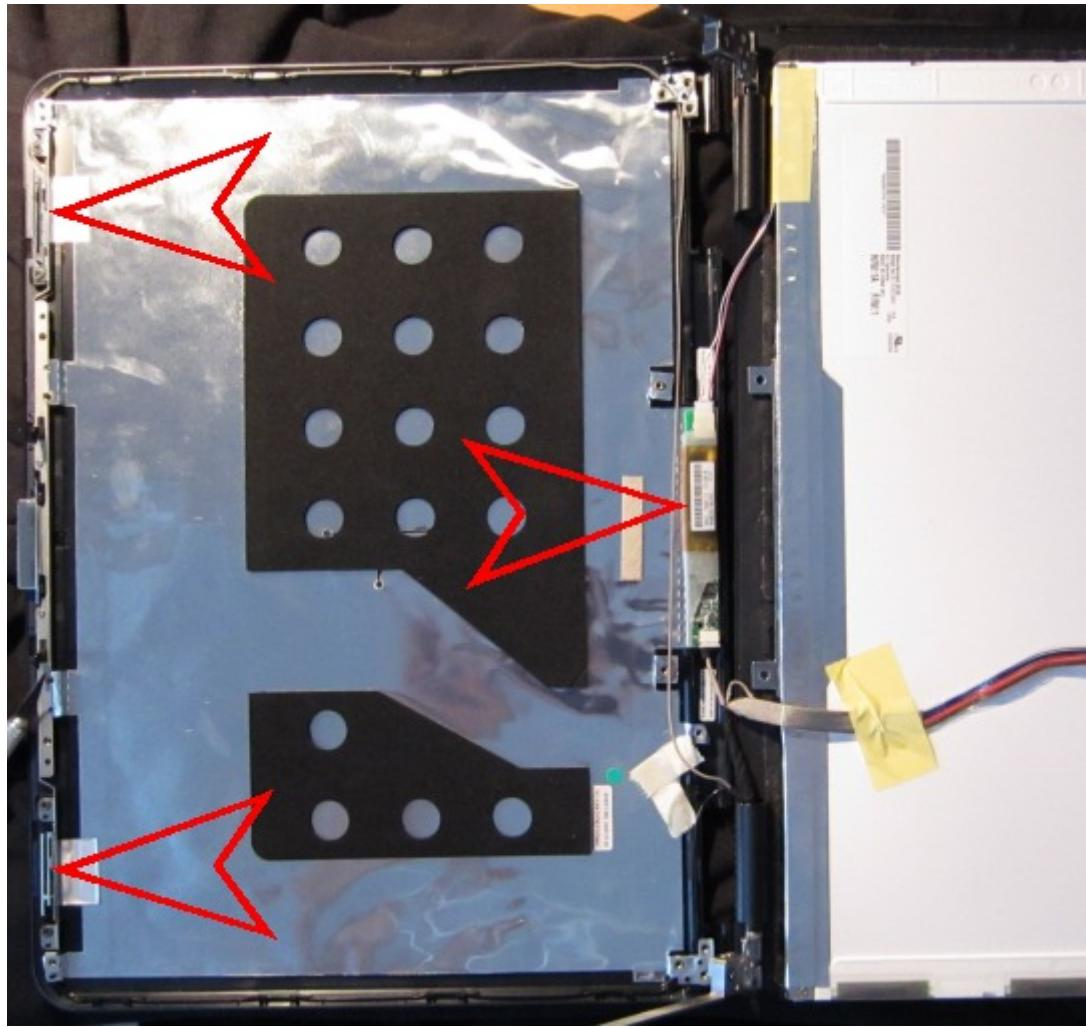
Der Masseanschluss der Antennen ist mit leitfähigem Klebeband zum Deckel ausgeführt. Dieses vorsichtig lösen, es kann nachher wieder angedrückt werden beim Rückbau :
