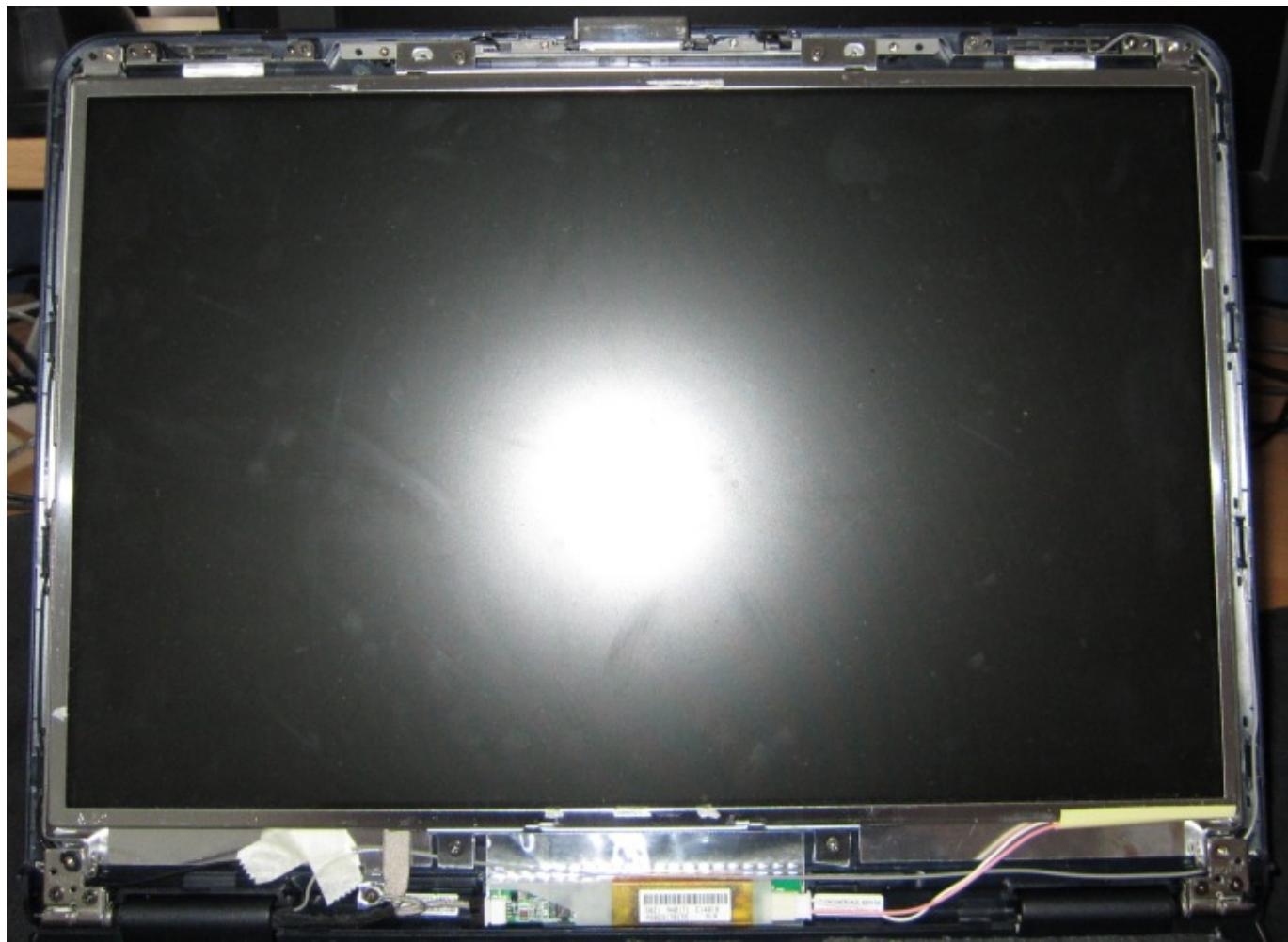
Nun die je 2 Schrauben an den Displayscharnieren unten sowie an den Seiten des Displays die je 3 Schrauben raus. Den Deckel dann neben den Notebook legen :
