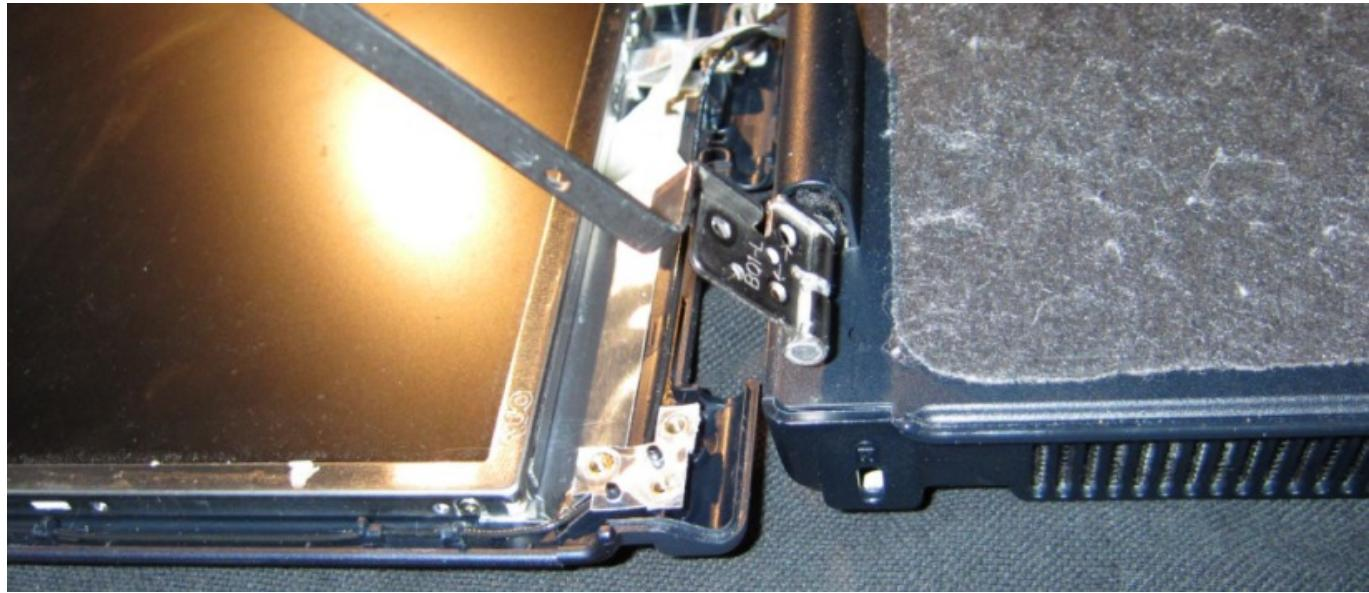
Zum herausschälen des Displays oben und unten je 2 Schrauben sowie die Schraube des Masseanschlusses lösen :
