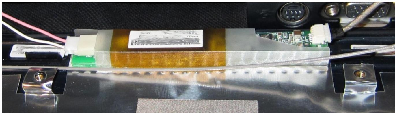
Der Deckel ist nun komplett vom Display getrennt und kann getauscht werden. Zusammenbau in umgekehrter Reihenfolge.
