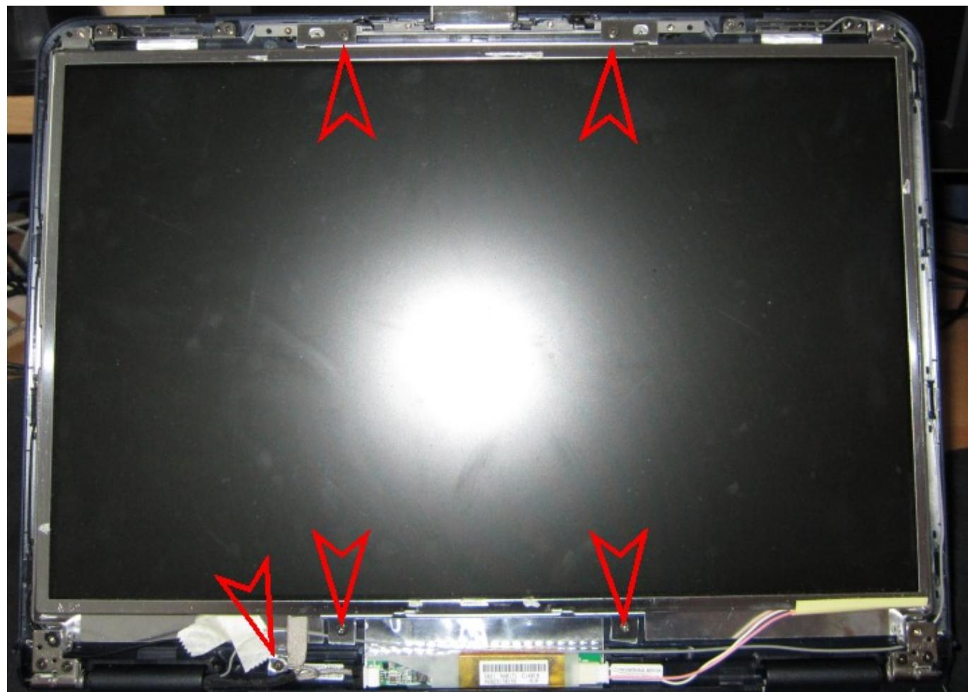
Aus dem Deckelgehäuse dann die beiden Antennenleitungen herausnehmen und die WLAN-Antennen herausschrauben:
