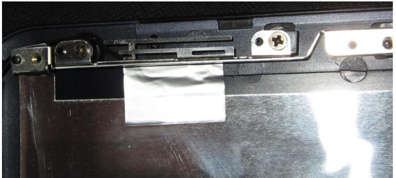
Dann den Spannungswandler der Hintergrundbeleuchtung vom Deckel abhebeln, die Schaltung sitzt in einem Vierkant-Plastikröhrrchen und ist mit doppelseitigem Klebenband befestigt:
