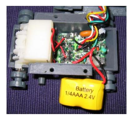
Ein kleiner Akku, 2 Mini-Motoren mit Getriebe sowie eine Platine. Auf der Oberseite befinden sich 2 H-Brücken zum Steuern der Motoren, auf der Rückseite der Microcontroller.
