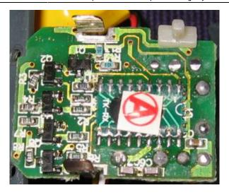
Der Controller ist interessanterweise als Bare-Die noch auf einer kleinen Trägerplatine aufgebracht und dann mit Harz vergossen worden.
