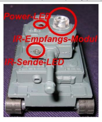
Im Turm des Panzers gibt es 3 Komponenten : - Power LED in Rot - Durchsichtiges Plastikteil (Innen konkav geformt) zur Weiterleitung der IR- Strahlung zum IR Empfänger - IR-Sende-LED zur Übertragung des "Schuss"-Kommandos
