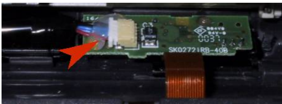
Stecker mit Fixierung aus Heisskleber. Der Klebepunkt kann mit einer Pinzette und etwas Kraft
