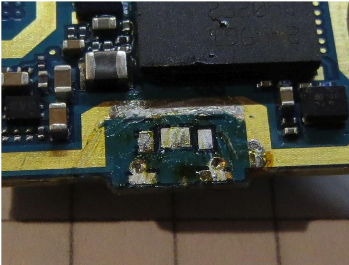
Neuen Schalter aufsetzen und am Gehäuse aussen vorne zuerst verlöten :
