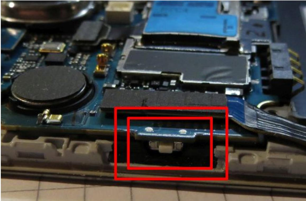
Also muss das Mainboard raus. Dazu 5 Folienverbinder (am besten einfach mit Fingernagel) abstecken sowie eine Schraube rausdrehen :
