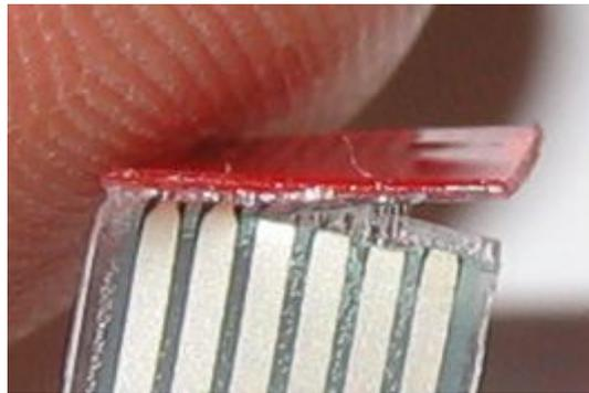
Die schnellste Reparatur besteht nun darin, das vordere Teil abzuschneiden, die beiden Folienteile des Kabel auseinanderzuziehen und auf der Kontaktseite den Lack auf den Leiterbahnen zu entfernen. Das geht mit dem Skalpell ganz gut wenn man seeehr vorsichtig vorgeht:
