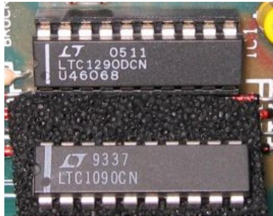
Ebenso gibt es die Möglichkeit das Auslesen der 8 Kanäle automatisch oder getriggert zu starten. Mit einem 10 MHz Quarz liegt die Ausgabedatenrate bei 19200 Baud, 8n1.
