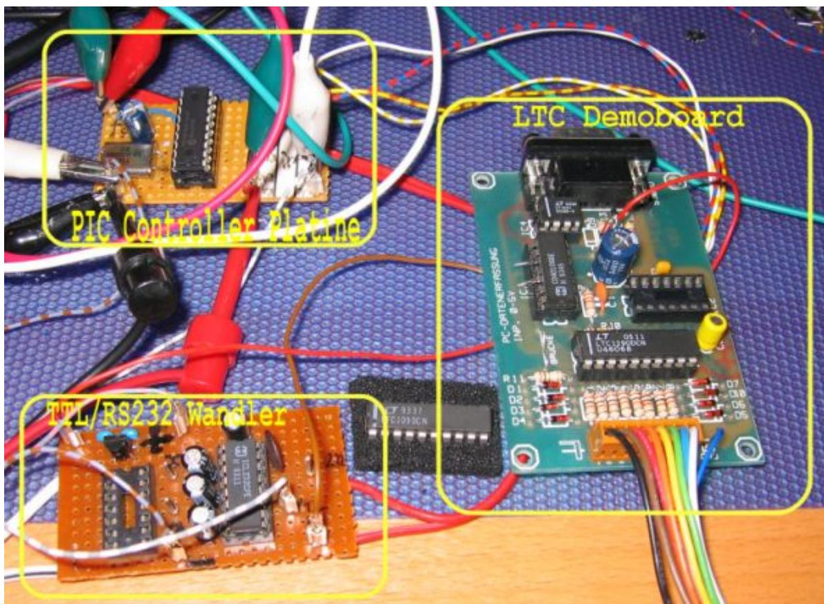
Hier noch der Demo-Aufbau aus dem CON\* Board, und separatem RS232-Wandler sowie der PIC-Controller-Platine
