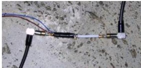
Umgebaute GPS-Antenne zur Einkopplung des Empfangssignales in den Garmin GPS 38
