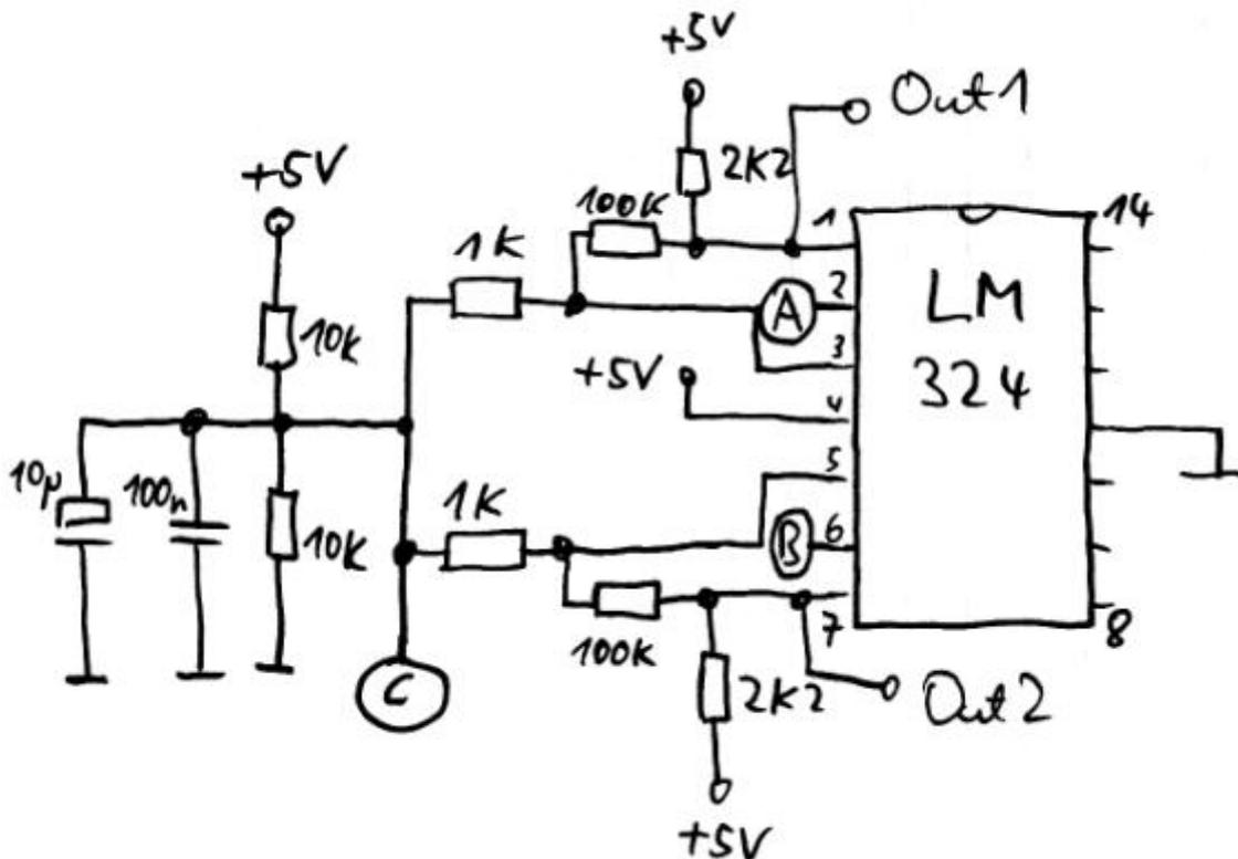
An diese Grundschaltung kommt nun die Impulsgewinnung aus den beiden Windungen des Stepermotors:
