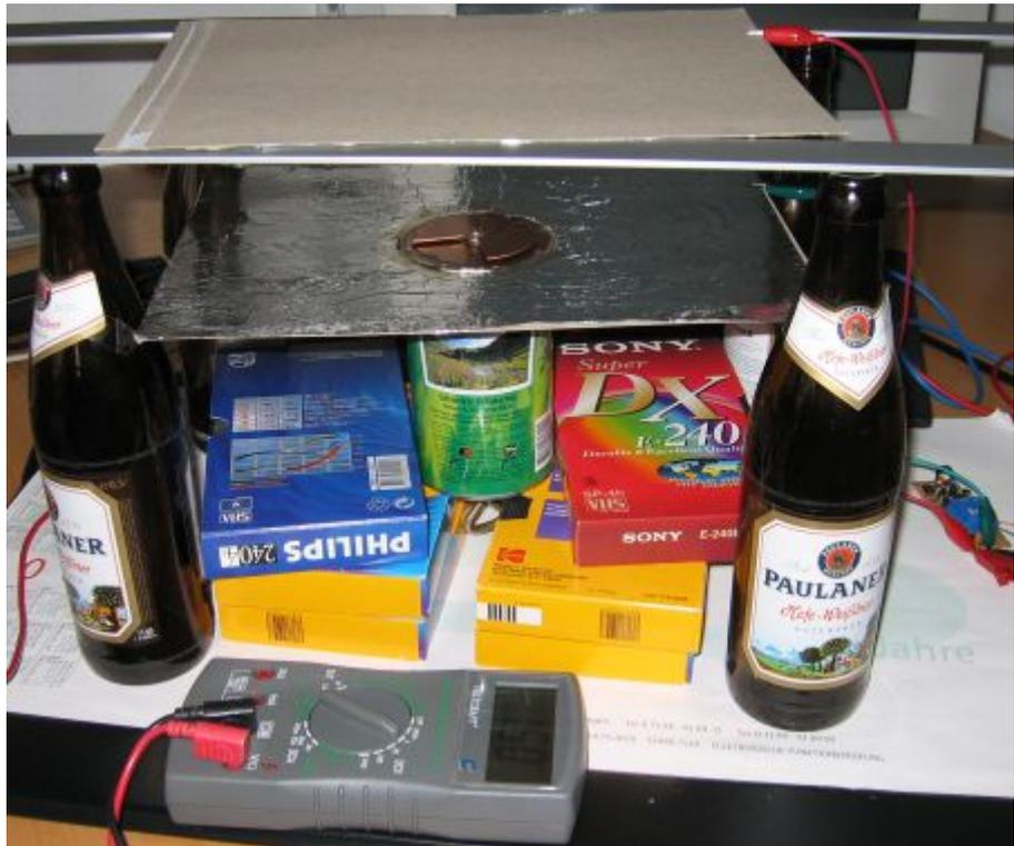
An beide Platten muss nun eine bekannte Spannung angelegt werden. Ich habe aus meinem Geigerzähler-Vorgänger-Projekt das Hochspannungsnetzteil entnommen, hiermit konnte ich dann Spannungen von 50...350V an die Platten anlegen, indem ich die Betriebsspannung von 1..5V mit einem Netzteil eingestellt habe.
