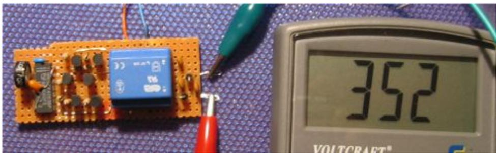
Jetzt kann die Feldmühle abgeglichen werden. Schließt man beide Platten kurz, so kann die Ausgangsspannung auf 0 eingestellt werden. Mit dem zweiten Poti läßt sich die Ausgangsspannung bei bekanntem Feld einregeln.
