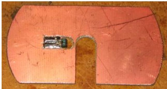
Die Platine wird dann auf der Rückseite einfach hart mit dem Motorgehäuse verlötet und fertig ...
