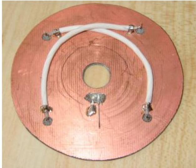
Für das Abdecken der Messplatten habe ich ein Kupfer-Plättchen ausgesägt. Dieses wird nachher oben auf die Motorwelle aufgeschraubt:
