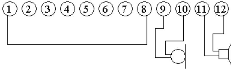
Schaltung des Siemens S35 Headset mit PTT-Funktion:
