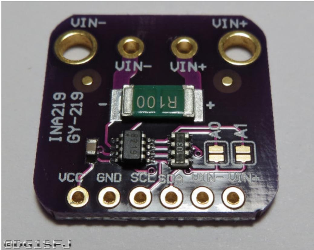
Der Vorteile dieser Mini-Module ist das der INA219 mit Shunt fertig aufgelötet ist und man per I2C die Strom und die Spannungswerte auslesen kann. Mit den Lötbrücken rechts kann man noch die I2C Adresse verstellen wenn man mehrere Module zeitgleich am Bus hat.
