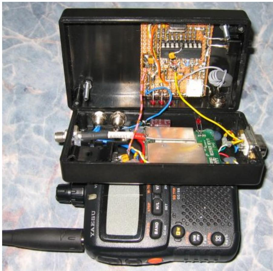
Geht schnell und funktioniert gut. Hier noch ein Bild von der Symbiose aus GPS-Empfänger und TinyTracker in Aktion:
