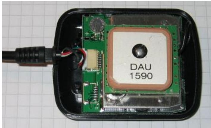
4. Auf der Unterseite wo das Antennen-Kabel in den Empfänger geht, einfach die Blechabschirmung und das Kabel ablöten:
