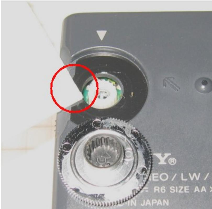
Anschließend vorsichtig den schwarz bedruckten Plastikleber abfummeln und die darunter liegende Schraube herausdrehen :
