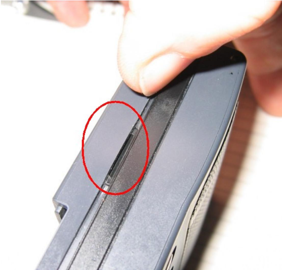
Als nächstes die Antenne abschrauben und herausnehmen, alle sichtbaren Schrauben lösen . Dann das schwarze Plastik-Abdeckteil abnehmen (aufgeklebt) :
