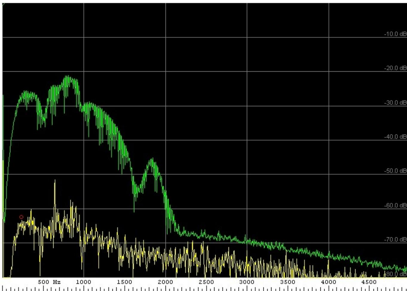
Nach Austausch Widerstände → Kondensatoren siehts dann so aus :
