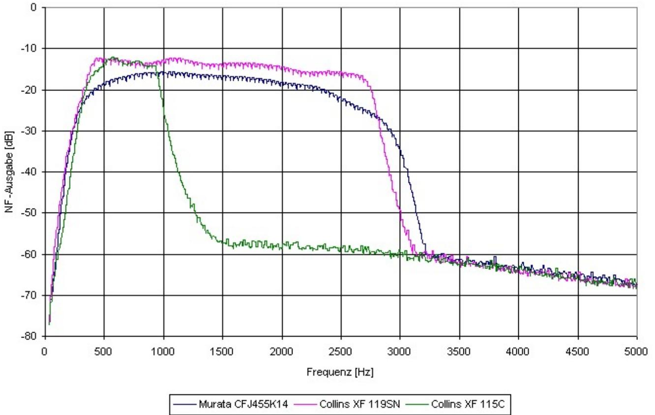
So sieht dann das CW Filter im Doppelfilter aus in der Messung :
