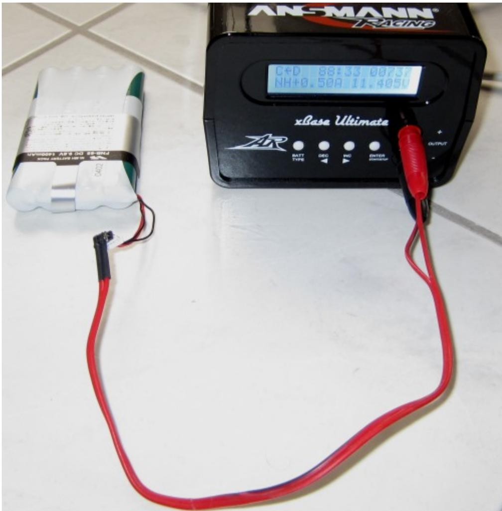
Ergebnis nach 4 Lade/Entladevorgängen : 1213mAh bei 500mA Strom
