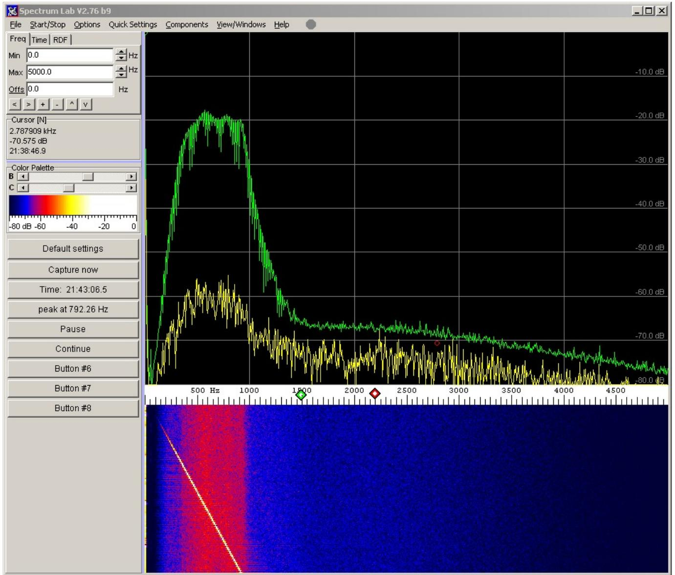
Und so unser SSB Filter der Doppelfilter Platine:
