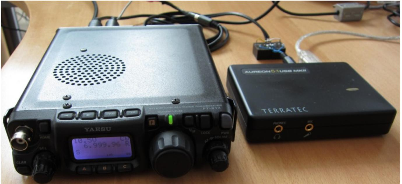
Im FT817 läßt sich ja normalerweise nur ein optionales Filter bestücken, so das man sich entscheiden muss ob SSB oder CW Filter. Dank einer kleinen Leiterplatte von Thorsten DL9SEC kann man nun beide Filter zeitgleich bestücken (Funkamateur Heft 1/2004). Das gute SSB Filter von Collins ersetzt dann das „günstige“ Murata SSB Filter.
