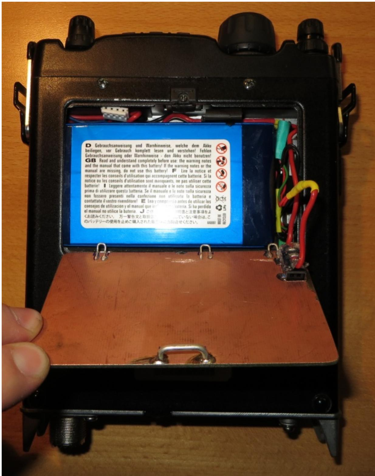
Noch ein Wort zum berühmten Grünen Draht : Wenn dieser auf die Plus-Leitung des Akkus gelegt wird, erkennt der Transistor via Spannungsteiler das eine Batterie angeschlossen ist und lädt nicht nach wenn das Gerät am Netzteil hängt. Der Grüne Draht misst also keine Spannung er stellt nur fest
