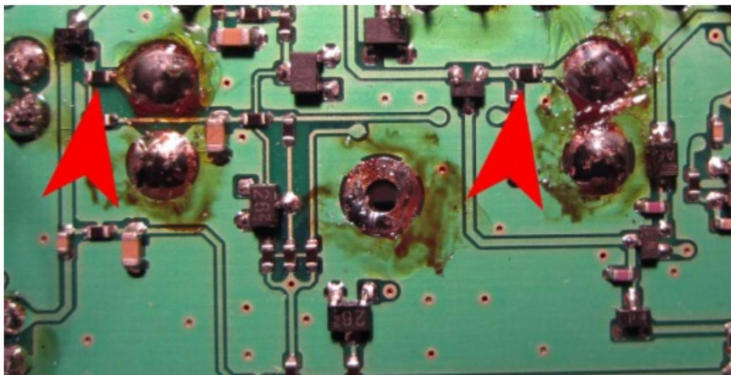
Diese müssen für korrekte Funktion ersetzt werden durch 2x10nF. Da ich das zuerst nicht wusste war ich schon schwer überrascht wie die unterirdisch schlecht die Übertragungsfunktion des 500Hz CW Filters aussah :
