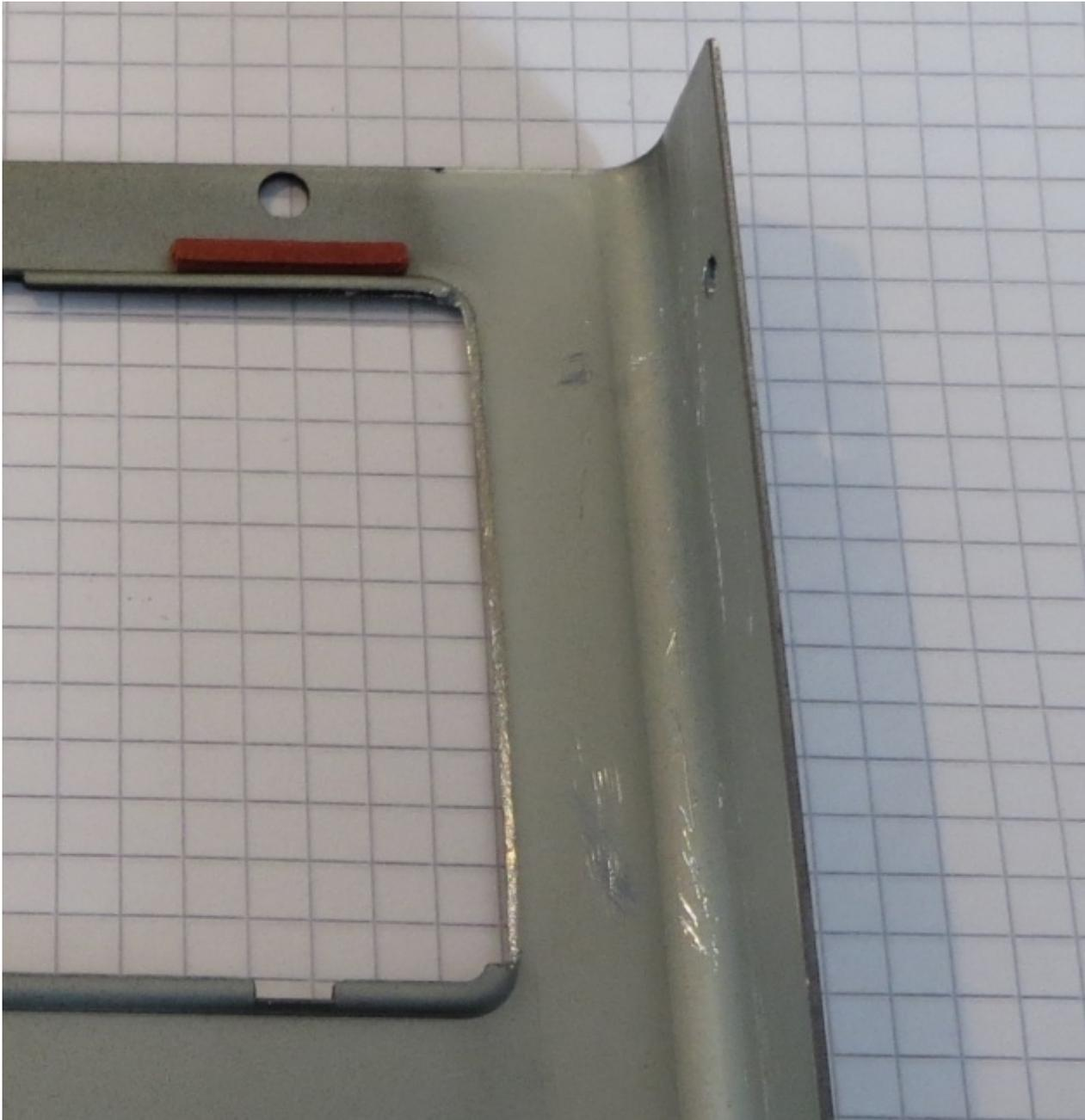
In den Deckel kommt jetzt ein rechteckiges Loch für den Schalter. Da ich keinen passenden Schalter fand mit niedriger Bauhöhe musste etwas gefummelt werden ... Füßchen unten abgeknippst, Plastikteil des Schalters gekürzt und Lack an der Seite entfernt zum festlöten am neuen Batteriedeckel.
