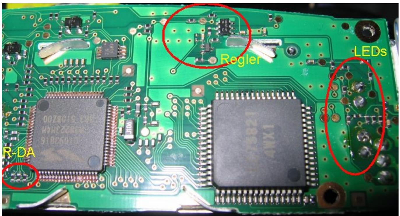
In meinem Gerät lag als Uin eine Spannung von 8,2V an. Pro LED waren es etwa 25,2mA Strom. Die Spannung am Ausgangs des Längsreglers lag bei 8,1V welche sich auf 6,05V beim 240Ohm und 2,04V bei der LED aufteilen.
