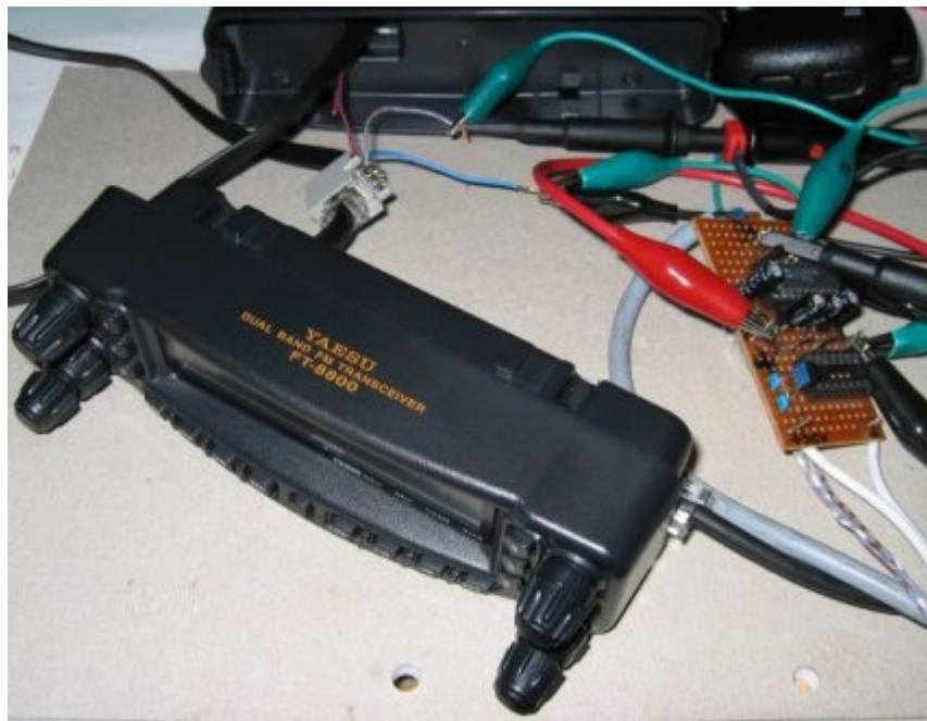
In zyklischen Abständen überträgt der Microcontroller des Funkgerätes ein Paket mit 42 Bytes. Es gibt keine Start/Ende-Kennung im Frame, so das nach einer ruhigen Lücke auf dem Bus von >1ms gesucht werden muss um den Anfang zu finden.
