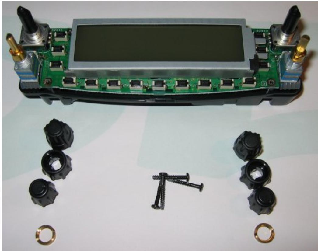
An der rechten Seite unter den Metall-Laschen kann man die beiden LEDs erkennen. Es handelt sich dabei laut Schaltplan um klare 3mm LEDs in Gelb von Toshiba (Nach Toshiba TLYH262 suchen. Typisch 2,1V mit 20mA)
