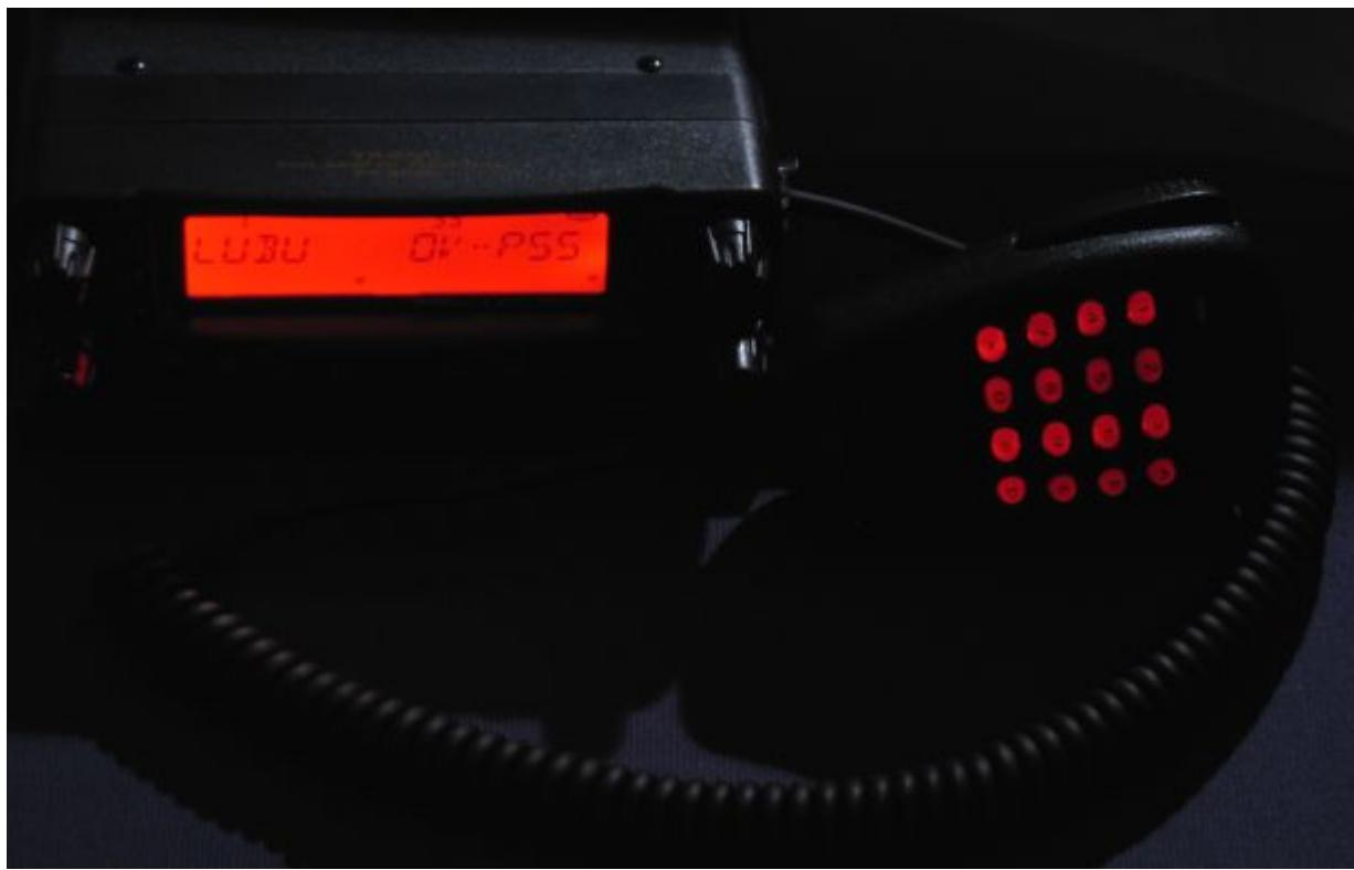
Die Absetzbarkeit des Bedienteils ist eine schöne Sache. Ein einfaches 6pol. Western-Kabel reicht aus und kostet nicht viel. Wie funktioniert aber die Übertragung der gedrückten Tasten und der Drehregler hin zum Funkgerät ?
