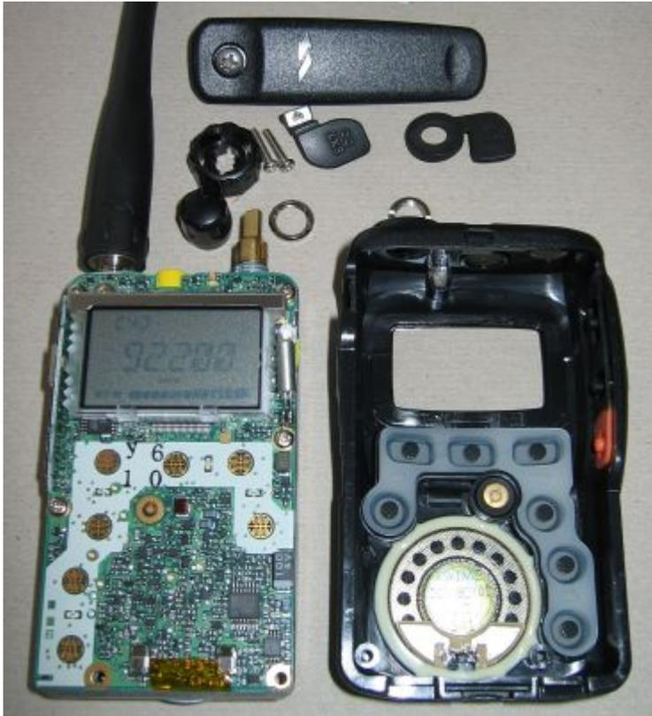
Hier zeigt sich dann auch schnell das Übel - der Lautsprecher wird nur mit Federkontakten am Lautsprecher angeschlossen. Das sorgt für mechanischen Abrieb und verhindert weiteren guten Kontakt auf Dauer.
