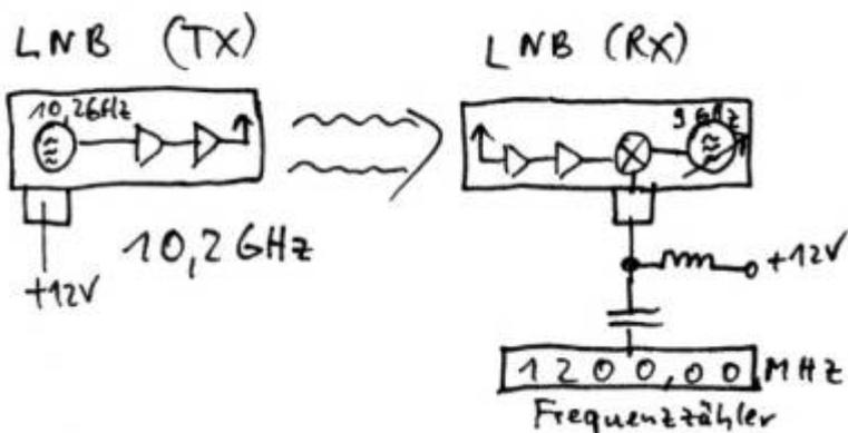
Unser Ziel ist nun, das wir 10,2GHz auf 1,2GHz mischen. Dazu muss die Resonanzfrequenz der Resonatorpille verkleinert werden. Das geht nur mit zusätzlichen Material - und das ist unsere zweite Pille. Diese mit einem Fräser oder Schleifpapier dünner feilen. Dann messen ob die Frequenz schon halbwegs stimmt, falls nicht weiter fräsen. Die Befestigung geschieht jeweils mit Sekundenkleber von der Seite auf die Original-Pille.
