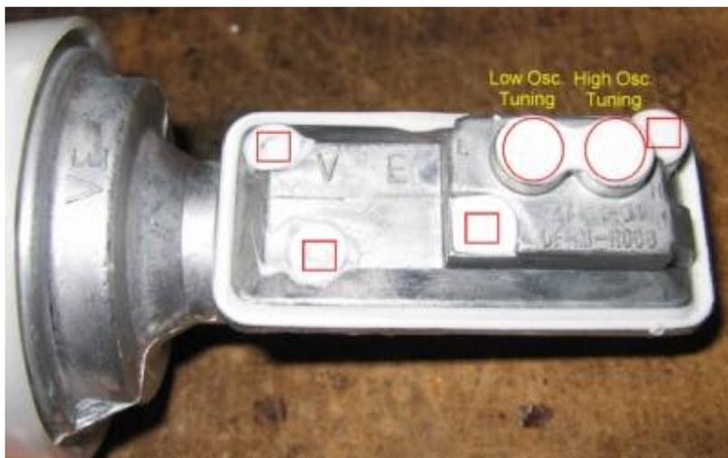
Innen sieht man die (im Vergleich zu älteren LNB's sehr winzige) Leiterplatte. Die Dickere Resonator-Pille ist für den unteren Frequenzbereich.
