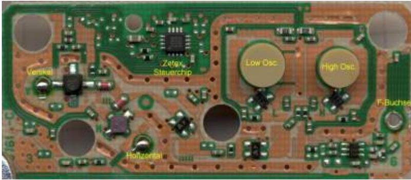
Jetzt die kleinere Pille (welche ja nicht mehr gebraucht wird) vorsichtig von der Leiterplatte ablösen. Das geht mit einer stabilen Pinzette sehr gut. Die Pille ist gut festgeklebt.
