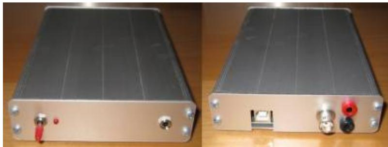
Vorderseite : Ein-Schalter und Power-LED, Rückseite : USB für den Oszillator, ZF-Eingang und Spannungsversorgung
