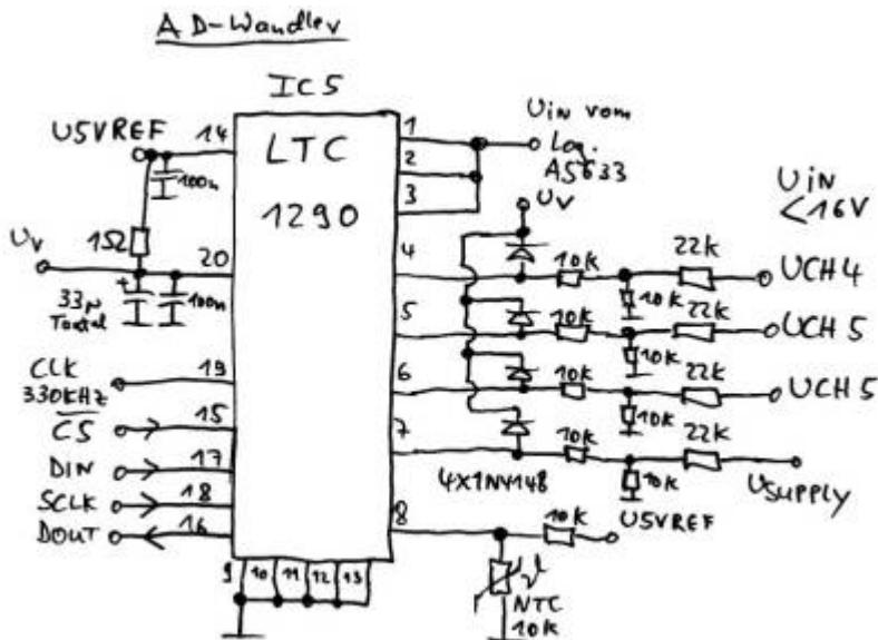
Mit den 3 freien Kanälen (bis 16V) kann z.B. eine ratiometrische Rücklesung eines Potis erfolgen die in einem Antennen-Rotor steckt.
