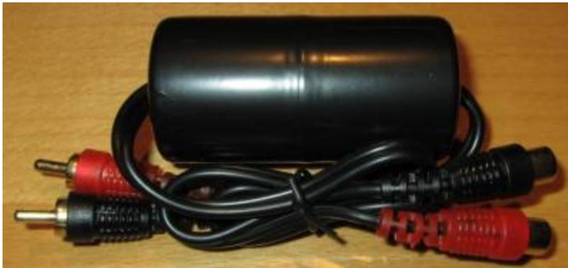
Schwarzen Schrumpfschlauch wegschneiden, Klebeband entfernen welches die beiden Aluhülsen zusammenhält :
