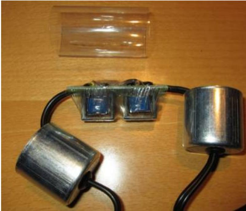
Prima, da sind die Übertrager. Auf der Unterseite noch die Gummiartige Schicht von den Löt pads abheben und per Entlötlitze die beiden Übertrager ausbauen.
