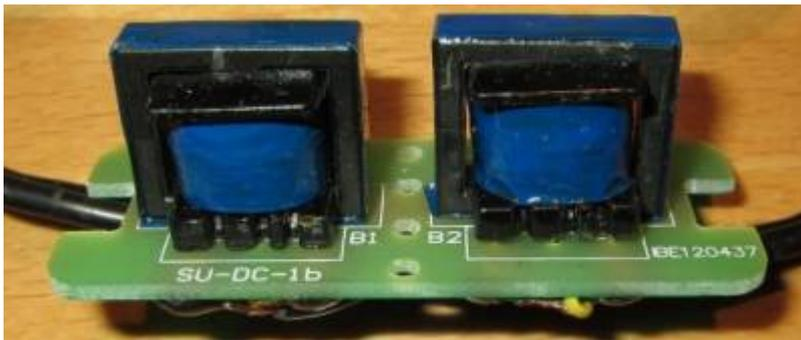
Die ausgelöteten Übertrager kann man nun in der Zielschaltung einbauen - oder wenn Platz ist schon ins Funkgerät oder die Soundkarte oder in ein extra Kästchen mit passenden Kabeln. Den Rest
