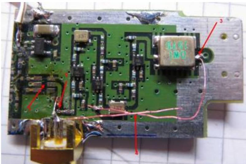
Betriebsspannung sollte größer 3,3 V sein da Onboard ein 3,0 V Spannungsregler verbaut ist. Bei 4,5V benötigt die Schaltung ca. 13mA. Nach einschalten gibts wie erwartet (wenns nicht gleich klappt an den beiden Drähten spielen) unser Prüfsignal auf ca. 1575MHz. Ausgangsleistung ca. 5dBm.
