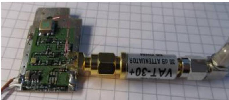
Der Umbau ist einfach : An Punkt 1 Balun entfernen, Bauteil 2 entfernen und Drahtbrücke einsetzen die auch zeitgleich zur Ausgangsbuchse geht und etwas weiter, am ehemaligen Antenneneingang ein Stück Kupferlackdraht anlöten und mit den beiden Drähten nahe beieinander eine winzige Koppelkapazität herstellen. Damit wird ein Teil des Ausgangssignals wieder auf den Eingang zurückgeführt und so wird aus dem Verstärker ein Oszillator.
