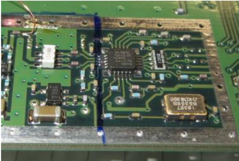
Dann braucht's nur noch den Versorgungsanschluß (U größer 3,3 Volt) und eine SMA-Buchse. Der SMD-Balun und ein paar Teile unten können entlötet werden. Auf dem Bild sieht man noch ein 30dB Dämpfungsglied.
